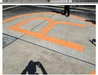
ビル屋上の陸屋根保護モルタルに施工して 9 ヶ月目です。煤煙汚れを受けやすい工業地帯の立地ですが光触媒施工部にはばい煙汚れはほとんどありません。「光触媒のセルフクリーニング効果は垂直面だけ」という従来の常識を根底から覆す現象です。
